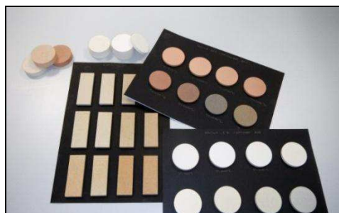
Ejemplo de probetas cocidas a diferentes temperaturas.
