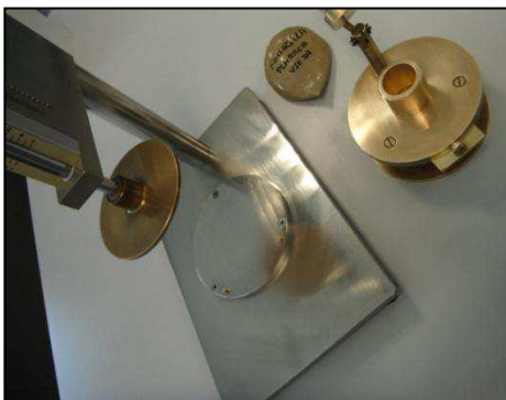
Plasticímetro Pfefferkorn. Realización del ensayo de determinación de la plasticidad.
