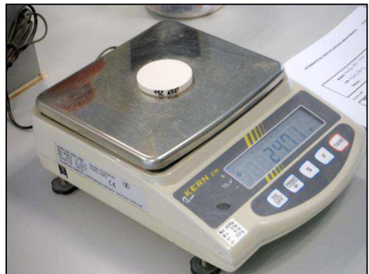
Probetas cocidas en horno de laboratorio. Báscula de precisión.
