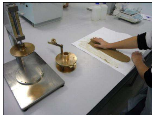
Plasticímetro Pfefferkorn. Realización del ensayo de determinación de la plasticidad.
